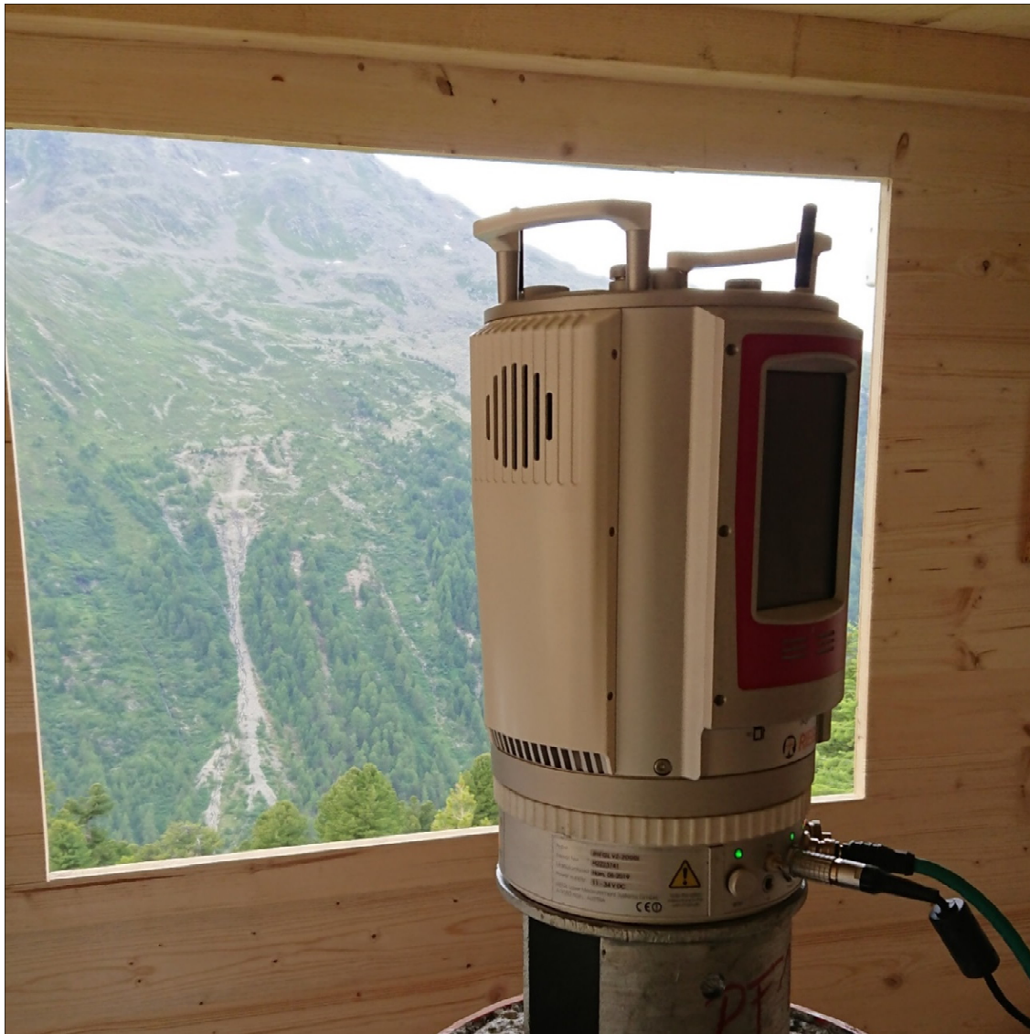
Abbildung 5: In der Messhütte: Scanner auf Betonsockel (von Hütte entkoppelt), Blick auf das Untersuchungsgebiet (Datum 15.07.2020).
