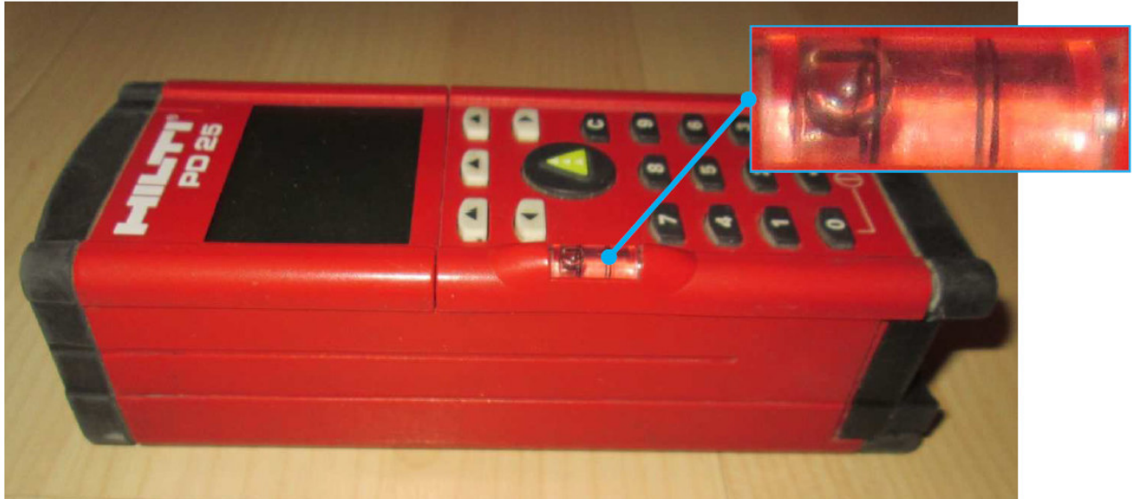
Bild 6: rund 6-7mm Höhenunterschied auf 15cm Länge
